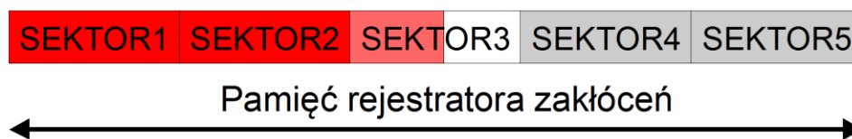
Rys.3.1. Przykład podziału pamięci rejestratora zakłóceń na 5 sektorów.
