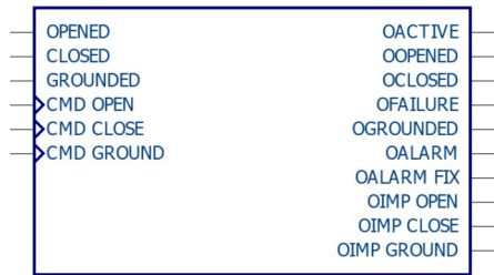
Rysunek 5.1. Blok funkcyjny A_DISCONNECTOR_EARTHING_01_02
