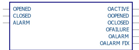
Rysunek 17.1. Blok funkcyjny A_VIEW_SWITCH_01_01
