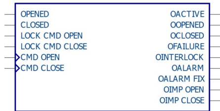
Rysunek 6.1. Blok funkcyjny A_EARTHING_07_01
