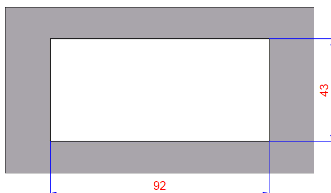
Rys. 8.2. Wymiary otworu montażowego VDIS-R
