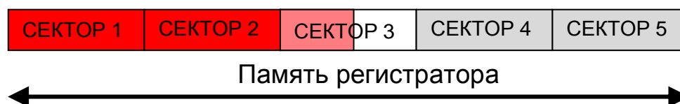
Рис.3.1. Пример распределения памяти регистратора событий на 5 секторов
